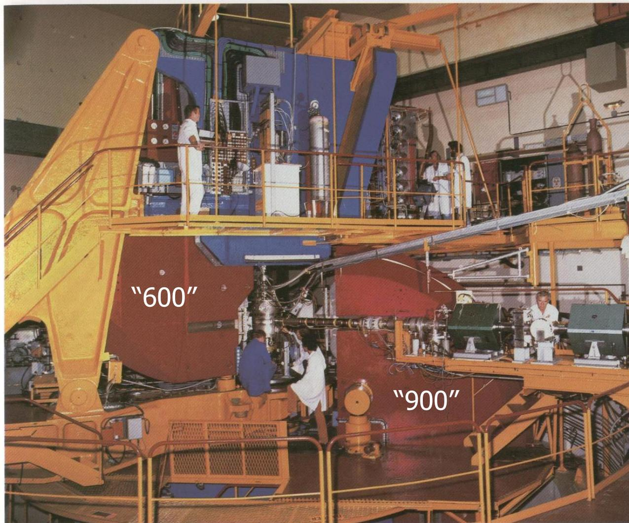
Ensemble des deux spectromètres utilisés pour la diffusion d'électrons.
