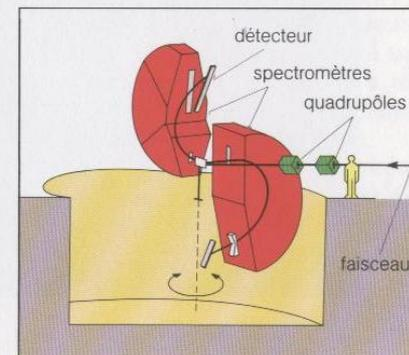
Éclaté schématique de l'ensemble des deux spectromètres.
