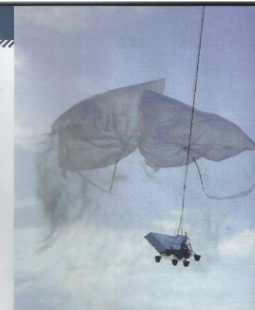
Le ballon stratosphérique Archeps, lancé en 2001, a permis de tester l'instrument à hautes fréquences du satellite Planck, dont il emportait une copie quasi exacte. © CNES
